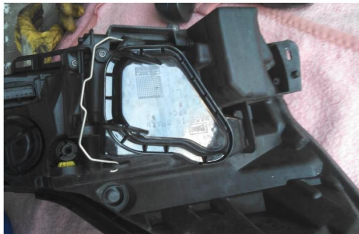
3. Jetzt wird der Deckel bearbeitet, denn dort muss das Kabel durch für den Xenonbrenner. Dazu den Deckel an die Scheinwerfer-Öffnung halten und man kann erkennen, wo der Xenonbrenner nachher eingesetzt wird. Am Deckel wird die Position für das Loch nun markiert und dann mit einem einfachen Bohrer vorgebohrt. Anschließend das Loch passend zum Gummistopfen für die Kabeldurchführung mit einem Kegelbohrer erweitert.
