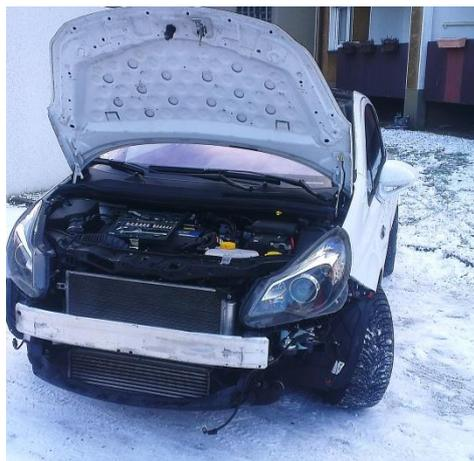
2. Jetzt geht es zum Ausbau der Scheinwerfer. Dazu müssen an jedem Scheinwerfer die drei Sechskantschrauben mit der Ratsche und passender Nuss gelöst werden.
