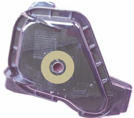
4. Nun muss eventuell der Xenonbrenner bearbeitet werden. Denn manchmal passt die H7 oder hier H11B Brenner (für H9B) nicht in die Sockel. So müssen die kleinen Haltenasen ein wenig bearbeitet werden. Daher vorher einmal in den Scheinwerfer einstecken und ausprobieren. Dann ggf. mit einem feinen Seitenschneider anpassen.
