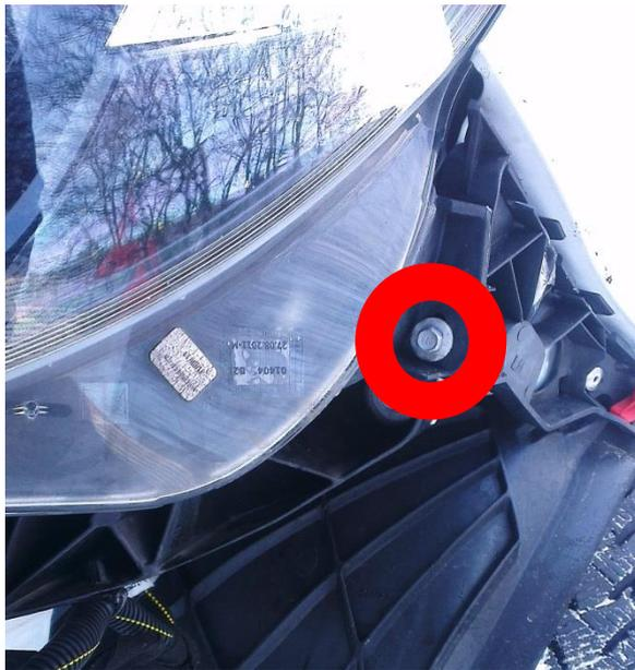
Danach lassen sich die Scheinwerfer abnehmen und müssen nur noch vom Stecker gelöst werden. Der Stecker hat eine rote Lasche und ist ein Bajonettverschluss. Einfach an der Kerbe zwischen roter Lasche und Steckergehäuse mit einem Schlitzschraubendreher leicht anheben und somit den Stecker entriegeln.
